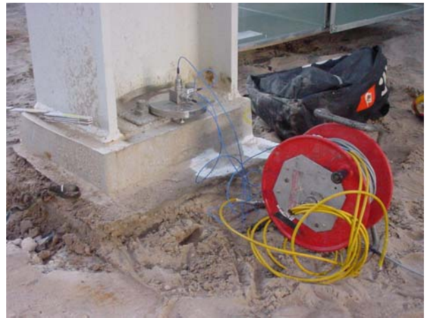
Figuur 9b : Versnellingsopnemer op de kolomvoet
